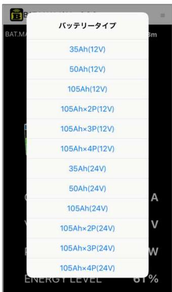
バッテリーネームの下にはバッテリー電圧および容量が表示されます。（初期値は12V系105Ahのバッテリーと表示されます）
