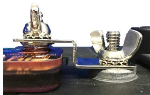
○付属金具を使用して本器のB A T T E R Y - 端子とサブバッテリーのマイナス端子を連結してください。
